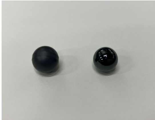
【図表4】窒化ケイ素ベアリングボール素球(左)と窒化ケイ素ベアリングボール完成球(右)の写真
