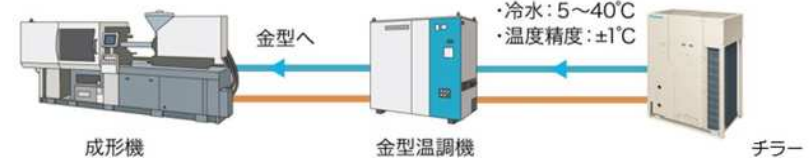
樹脂成型機の金型温調器の冷却の例
