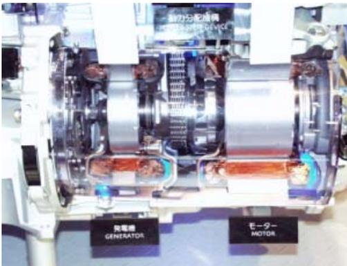
写真はトヨタ殿/プリウス駆動用モーター
